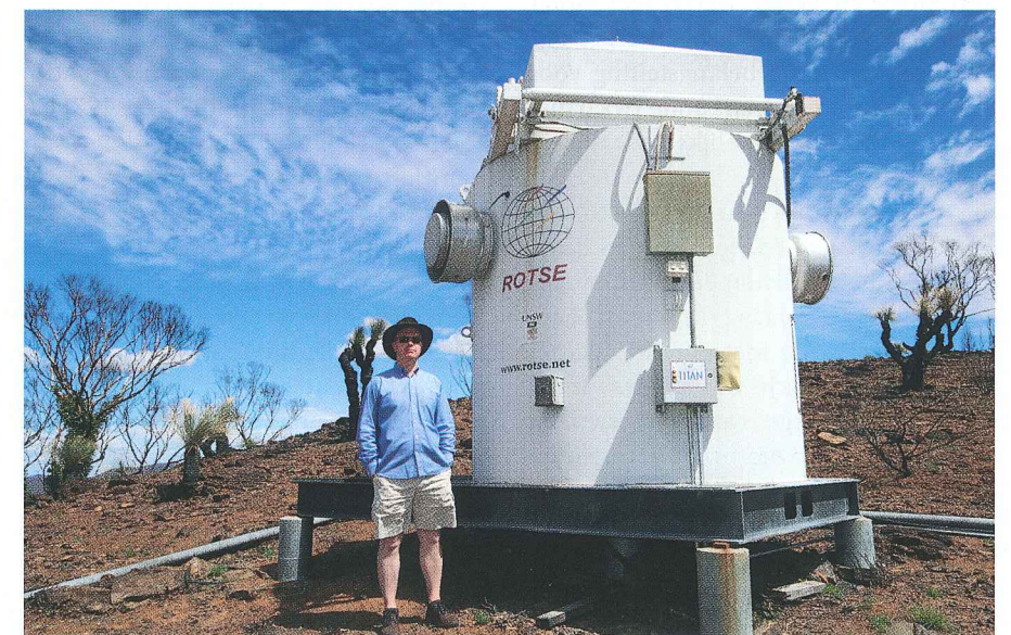
De auteur nabij de ROTSE-IIIa container op de Siding Spring sterrenwacht in Australië. De container met klapdeksel bevat een geautomatiseerde 45 cm Cassegrain reflector op parallactische vorkmontering en alle nodige computerapparatuur, inclusief weerstation. (Foto: Philip Corneille)
